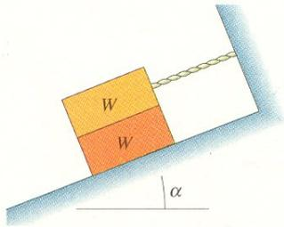
**10.16** Considere el sistema del problema 10.15. El coeficiente de fricción estática entre las dos cajas y entre la caja inferior y la superficie inclinada es  $\mu_s$ . Si  $F = 0$ , la caja inferior se deslizará hacia abajo sobre la superficie inclinada. ¿Cuál es la fuerza  $F$  mínima para la cual las cajas no se deslizarán?
