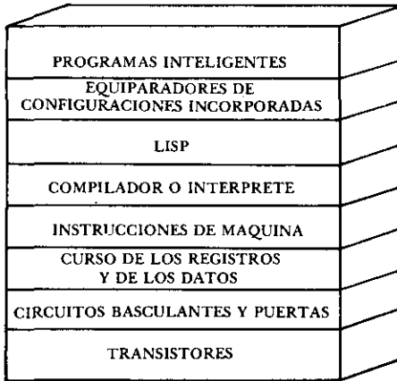
Figura 59. Para crear programas inteligentes, es necesario construir una serie de niveles de hardware y de software, a fin de evitar la angustia de verlo todo únicamente en el nivel más bajo. Las descripciones en distintos niveles de un mismo proceso darán la impresión de ser muy diferentes entre sí, pero sólo cuando el nivel superior esté lo suficientemente articulado en bloques como para que nos sea comprensible. [Adaptado de P. H. Winston, Artificial Intelligence (Reading, Mass.: Addison-Wesley, 1977).]
