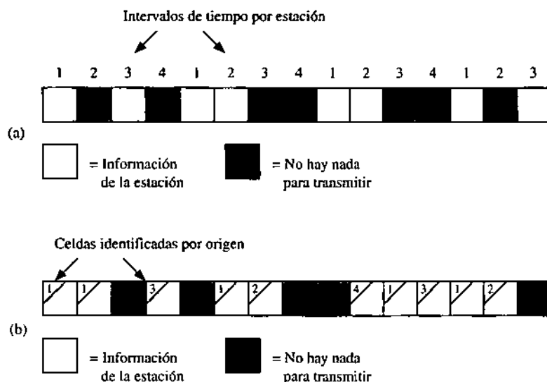
Figura 9.20 • (a) Multiplexado por división del tiempo versus (b) modo asincrónico de transferencia.
